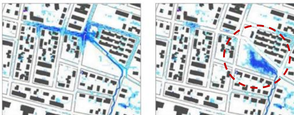
Példa az elöntési területek lehatárolására Malmőben az áramlási útvonalakat megjelölve. A jobboldali ábra azt mutatja, hogy amennyiben a park (pirossal jelölve) felületén hatékony vízvisszatartás történik, az elöntési területek kiterjedése jelentősen csökkenthető
